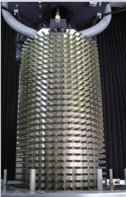
Teilebeispiel: Rotor aus Edelstahl für die Lebensmittelindustrie, 560 mm hoch, Außendurchmesser 350 mm
